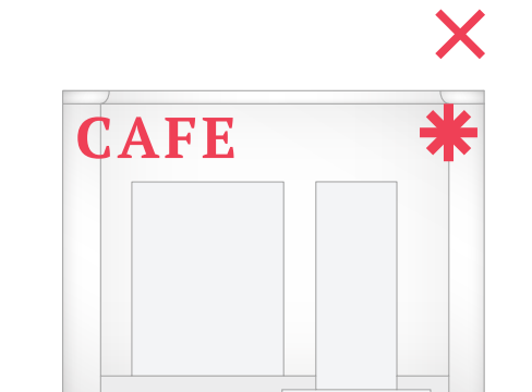
Размещение вывесок на любых элементах и деталях конструкции здания
